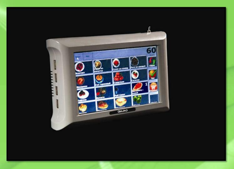
Полноценный компьютер небольшого размера. С обратной стороны имеет разъемы для подключения к стандартным кронштейнам VESA 75 или для того, чтобы просто подвесить его на стену.
