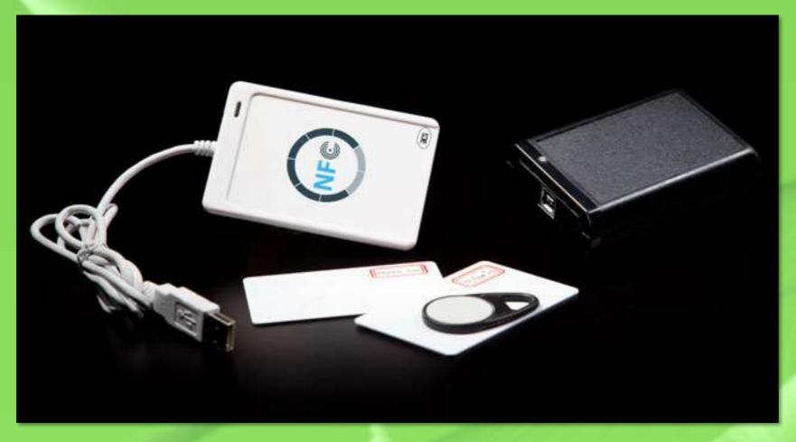
Карты могут быть обычной прямоугольной формы или выполнены в виде брелка, используют один из самых распространенных стандартов обмена. К сенсорному терминалу можно подключать считыватели как импортных, так и отечественных производителей.
